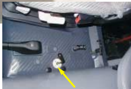
Die Bremskraft lässt sich vom Fahrersitz aus durchführen und erfolgt analog zur Druckluftanlage (Pfeil).
