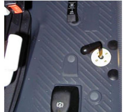
Die Einstellvorrichtung für den Anhängerbremsdruck kann bequem vom Fahrersitz aus bedient werden.
